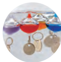
気温は、上部に浮いているガラス球体に付いているプレートの最小数値で読み取ります。(温度目盛:18~26度)
